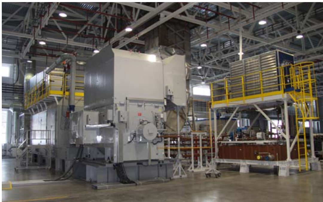
Энергетический газотурбинный агрегат ГТА-16 мощностью 16 МВт на испытательном стенде компании
